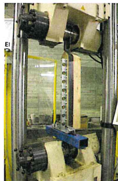
LPR zs longitudinale avvitato su travetto in legno
