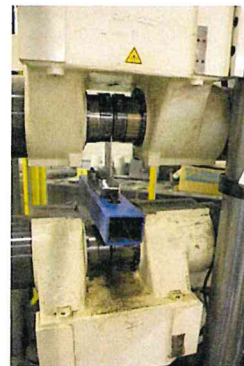
LPR zs longitudinale avvitato su travetto in legno
